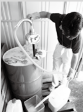
燃料保管庫のバイオディーゼル燃料。ドラム缶のハンドドルを一回転回すと1リットル入る
